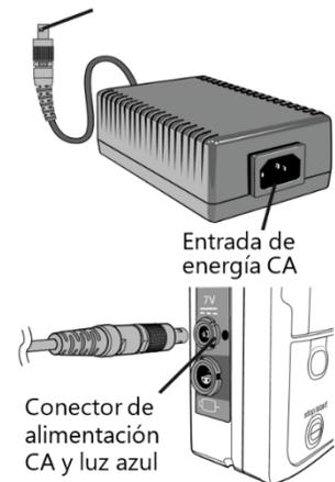
**PRECAUCIÓN: No empujar el conector del adaptador de CA hasta que haga tope en el conector de alimentación puede tener como resultado una conexión intermitente y el conector puede desplazarse, lo que provocaría la pérdida de energía en la bomba.**
